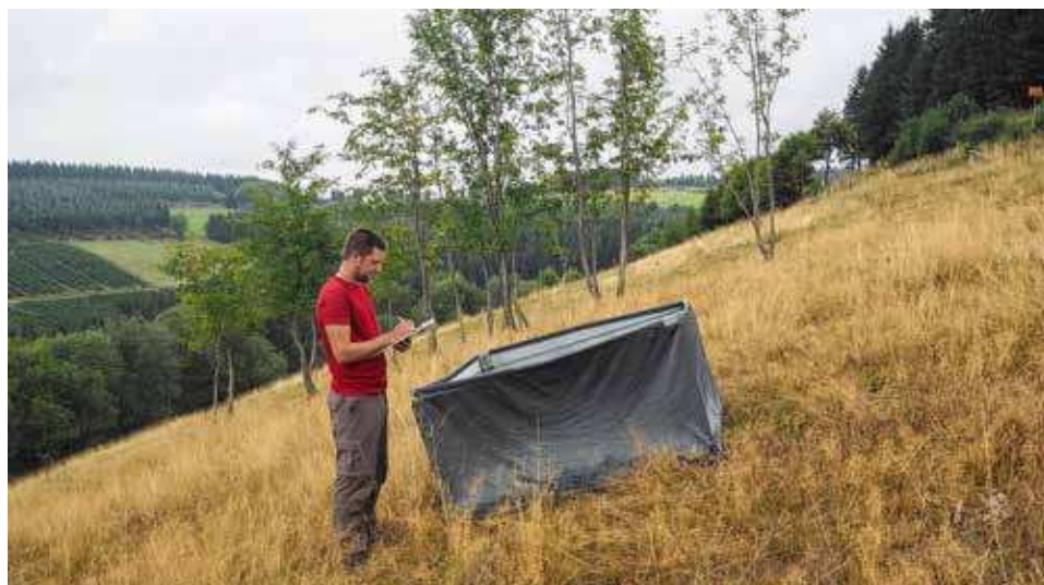
Abb. 3: Trotz seiner Größe eignet sich das Isolationsquadrat dank des leichten und mobilen Gestänges sehr gut für die Erfassung von Heuschrecken im Gelände, denn Arten- und Individuenzahlen lassen sich damit präzise ermitteln
